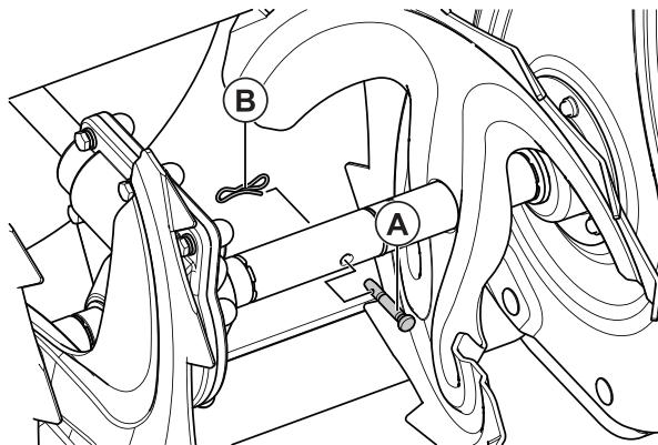
Шнеки крепятся к валу с помощью предохранительных (резных) штифтов. В случае столкновения шнека с посторонним предметом или ледяным затором, штифты срезаются и шнек перестает вращаться, предотвращая повреждения других частей снегоуборщика.
